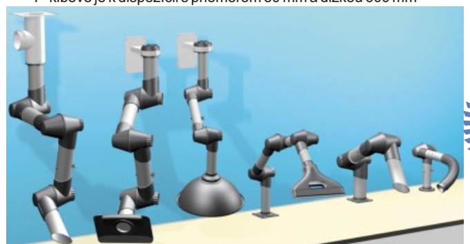
Montáž na strop 3-kĺbové rameno Ø 75 mm sacia dýza na stenu 3-kĺbové ram. Ø 75 mm plochý sieť nadstavec na stenu 2-kĺbové ram. Ø 50 mm miskovitá hlavica na stôl 3-kĺbové ram. Ø 50 mm dýza „rybí chvost“ na stôl 2-kĺbové ram. Ø 75 mm sacia dýza na stôl 1-kĺb. ram. Ø 50 mm pružná trubica
